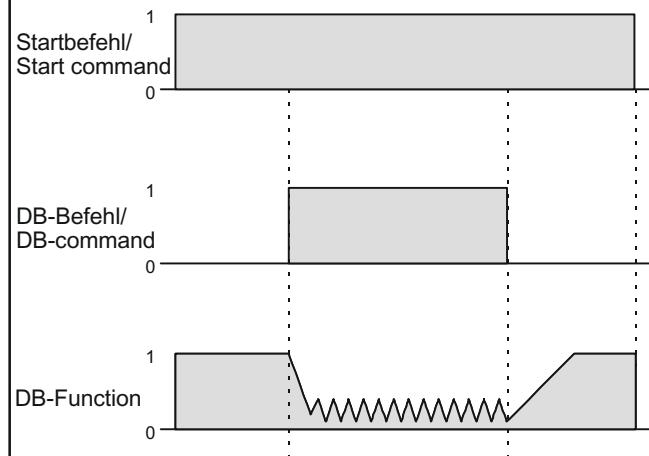
Die GS-Bremsung wird mit dem Ende des DB-Befehls beendet.
