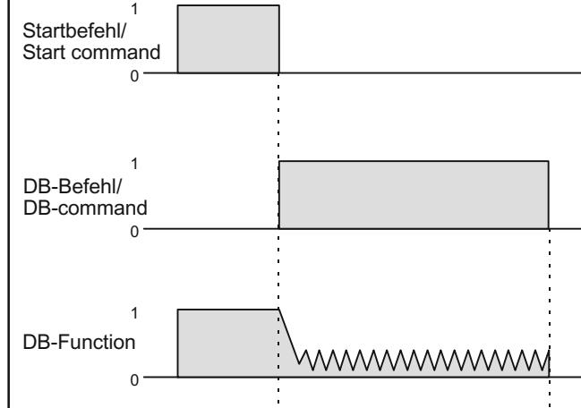
Die GS-Bremsung läuft, solange der DB-Befehl ansteht.
