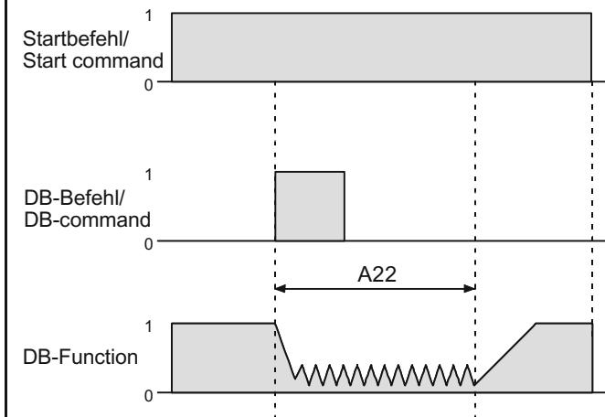
Die GS-Bremsung läuft, bis die eingestellte Zeit (A22) aus ist.
